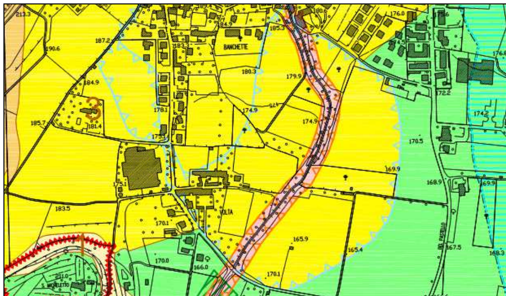
Carta delle Fragilità con delimitazione delle aree a rischio esondabilità (▲▲▲▲)
