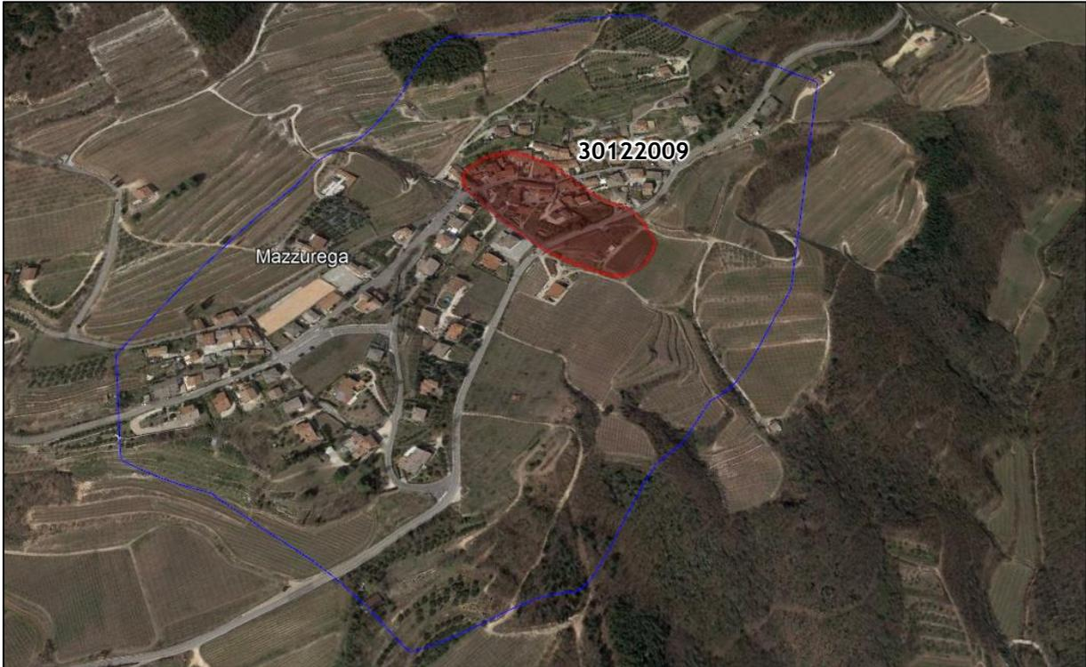
Al fine di verificare la stabilità in condizioni sismiche, è stato effettuato uno studio di stabilità di versante in condizioni dinamiche, secondo il metodo pseudo-statico di Newmark su tale dissesto, segnalato nella cartografia PAI come frana di scorrimento attiva con pericolosità elevata (cod. 0230066400 - P3).
