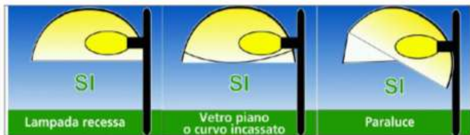
Fig. 2 - Apparecchi conformi alla L.r. 17/09.
