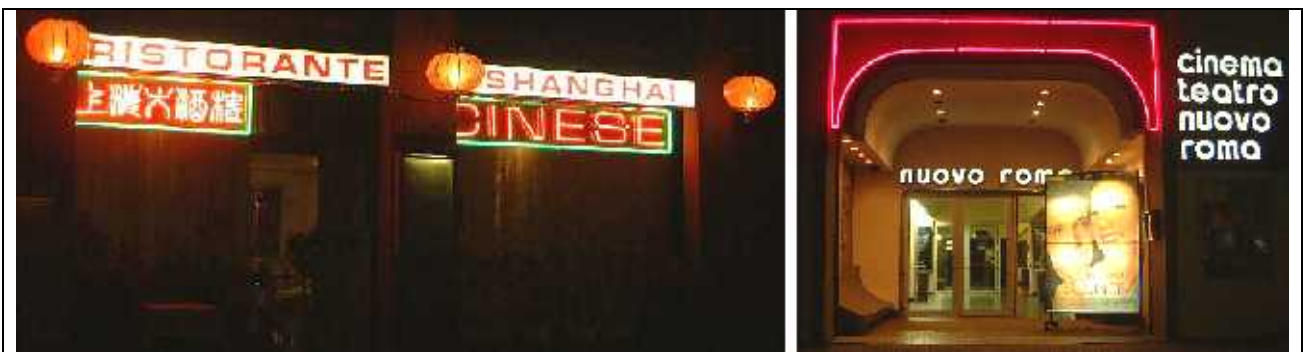
Fig.14 – Alcuni tipi di insegne in deroga alla legge in quanto neon nudi o scatolati con emissione complessiva inferiore a 4500lm.
