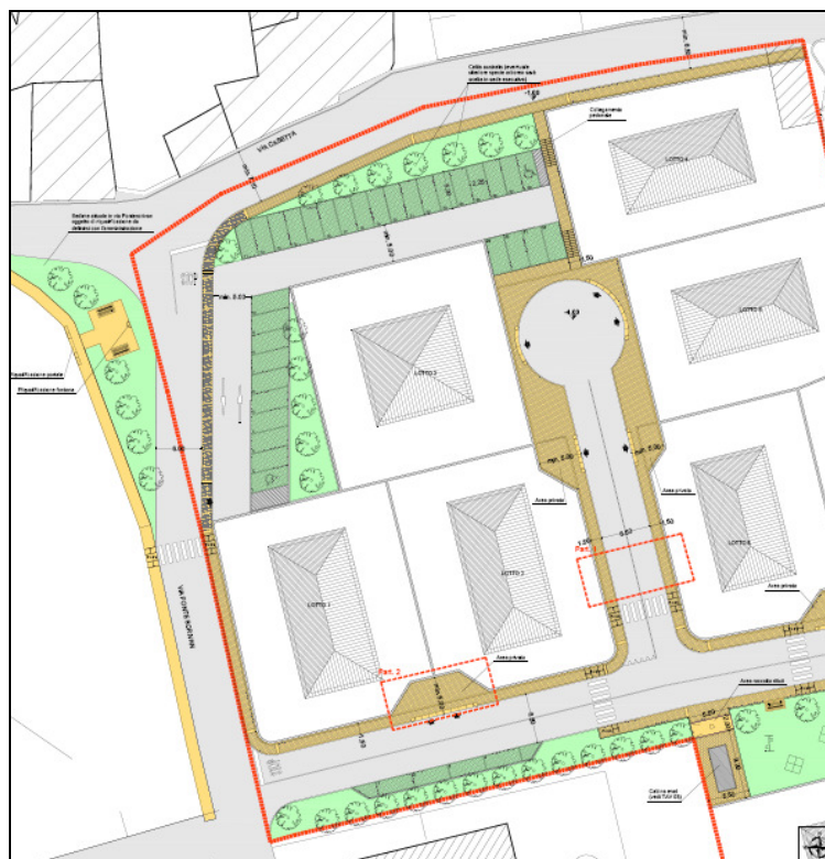
Figura 11 - Riqualficazione tratto SP 33/B e realizzazione percorsi pedonali
